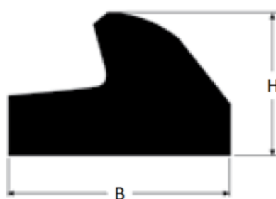
Figure 6 : Profil type DS-GS (EPDM, SBR, NBR) pour type C
