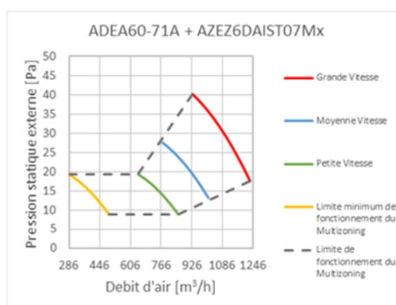
Figure 12 – Unités intérieures ADEA60A et ADEA71A Courbes débit/pression
