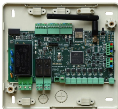
Figure 4b – Contrôleur central - de type AZXXXCB1IAQY
