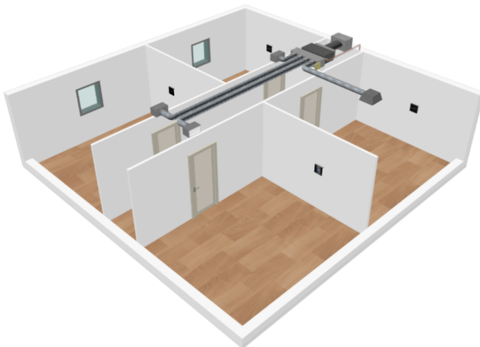
Figure 1a - Schéma de principe du système « Gainable Daikin et Multizoning Airzone »
