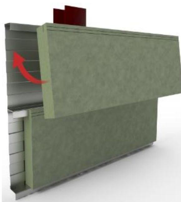
Figure 10 – mise en œuvre de l'isolant à l'intérieur des plateaux
