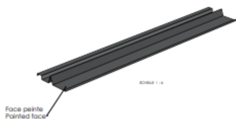
Figure 16 – Abergement métallique standard droit
