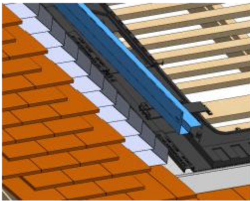
(Vue éclaté, noquets sans les ardoises)
