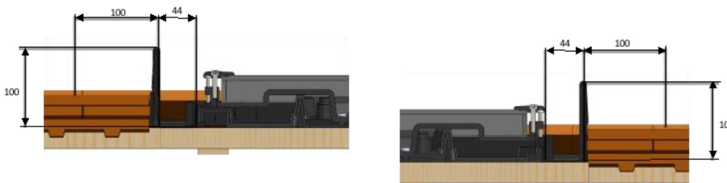
Figure 64 - Mise en place des éléments de couverture pour le Kit TP
