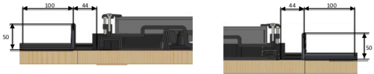
Figure 65 - Mise en place des éléments de couverture pour le Kit FAG à relief
