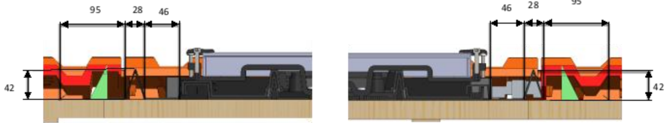
Figure 65 - Mise en place des éléments de couverture pour le Kit FAG à relief
