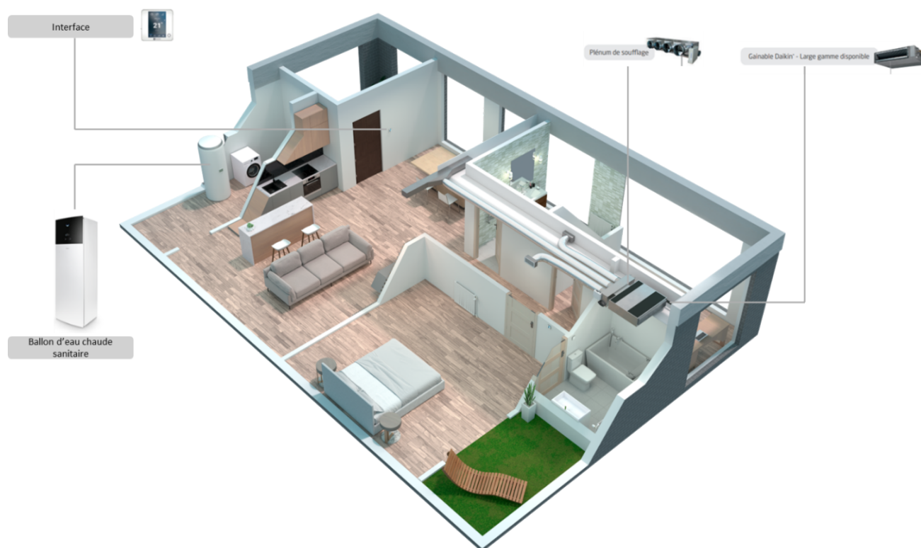
Figure 1c – Schéma de principe de la solution Multi+ avec gainable + multizoning
