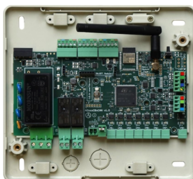
Figure 4b – Contrôleur central - de type AZXXXCB1IAQY
