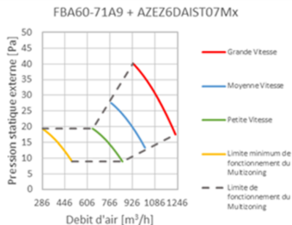
Figure 8 – Unités intérieures FBA60A9 et FBA71A9 Courbes débit/pression
