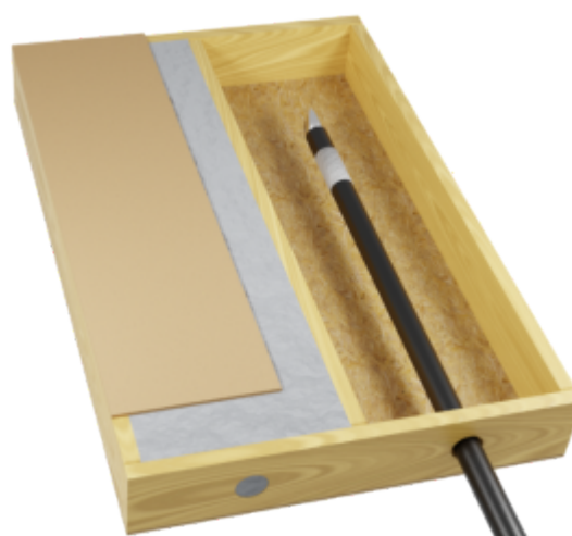
Figure 4 : Lance : percements dans une extrémité des caissons
