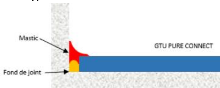
Figure 7 : Traitement des découpes et des joints périphériques dans le cas des locaux U4 et des locaux E2 et sur supports bois ou à base de sulfate de calcium
