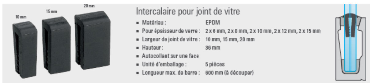
Figure 24 – Intercalaires BA-ZP pour joint de vitre
