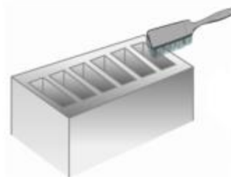
Etapes 1 et 2 : retrait de la coiffe existante et nettoyage de la partie supérieure du conduit
