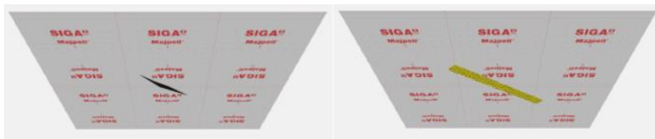
Figure 17 - Réparation d'une petite entaille
