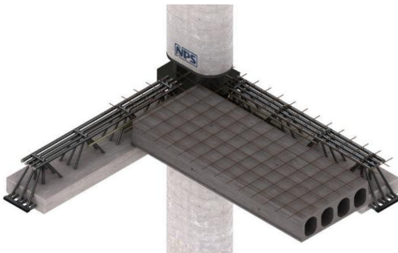
Figure 16. Dalle alvéolée associée au système NPS®
