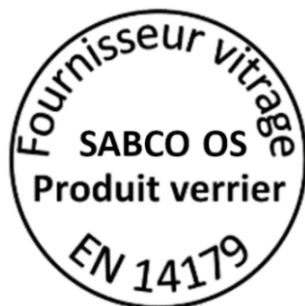
Figure 24 – Exemple de marquage sur le verre
