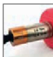
Figure 27 – Tournevis dynamométrique de serrage des cales
