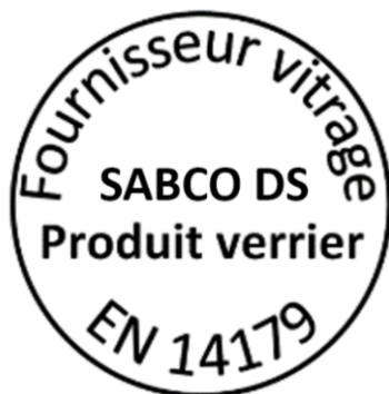
Figure 24 – Exemple de marquage sur le verre
