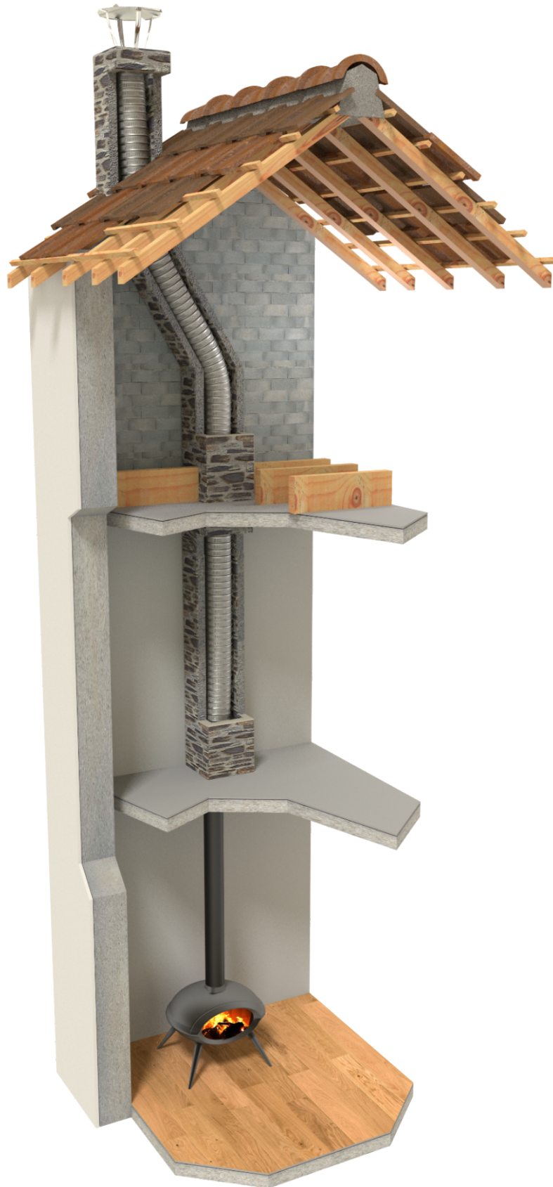
Figure 4 – Procédé TENFLEX-DP – Réutilisation d'un conduit existant
