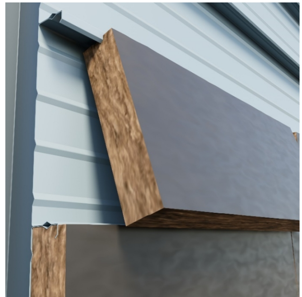
Figure 12 - Mise en œuvre de l'isolant à l'intérieur des plateau
