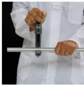
Fig. 1 Découpe des tubes Pipe cutting
