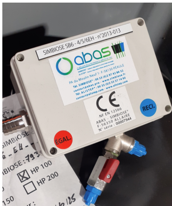
Figure 1 : Etiquette d'identification placée sur le boîtier distributeur d'air (exemple SB 4/5/6EH)
