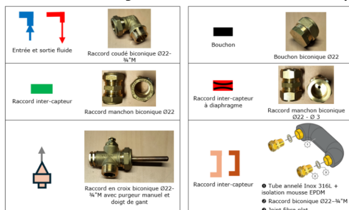
Figure 19 – Accessoires pour raccordement hydraulique des capteurs CEV et CMV
