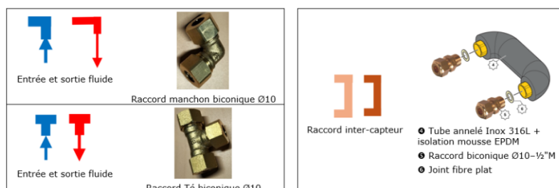
Figure 20 – Accessoires pour raccordement hydraulique des capteurs CSH
